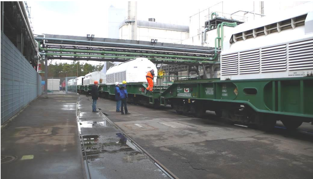
Im Februar 2011 auf dem Gelände der WAK zum Abtransport bereitstehende, mit Glaskokillen beladene Castor-Behälter
