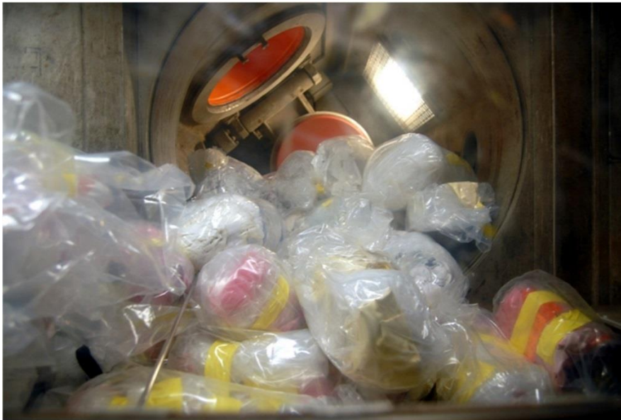
Beschickungsbox der Verbrennungsanlage bei den Entsorgungsbetrieben
