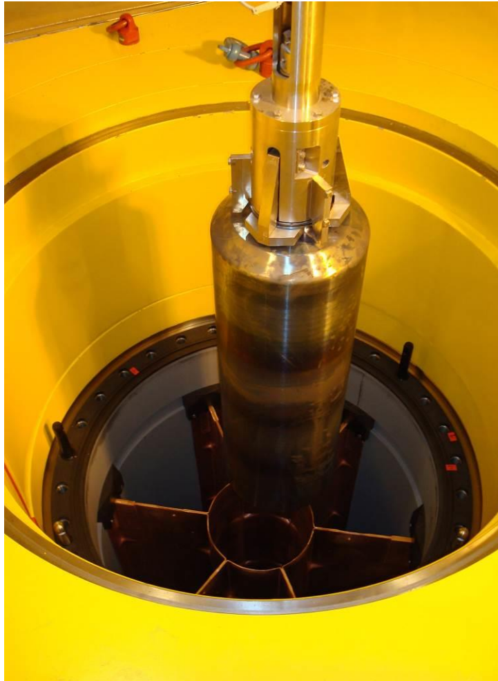
Castor-Beladung mit einer Glaskokille („kalte“ Handhabung)
