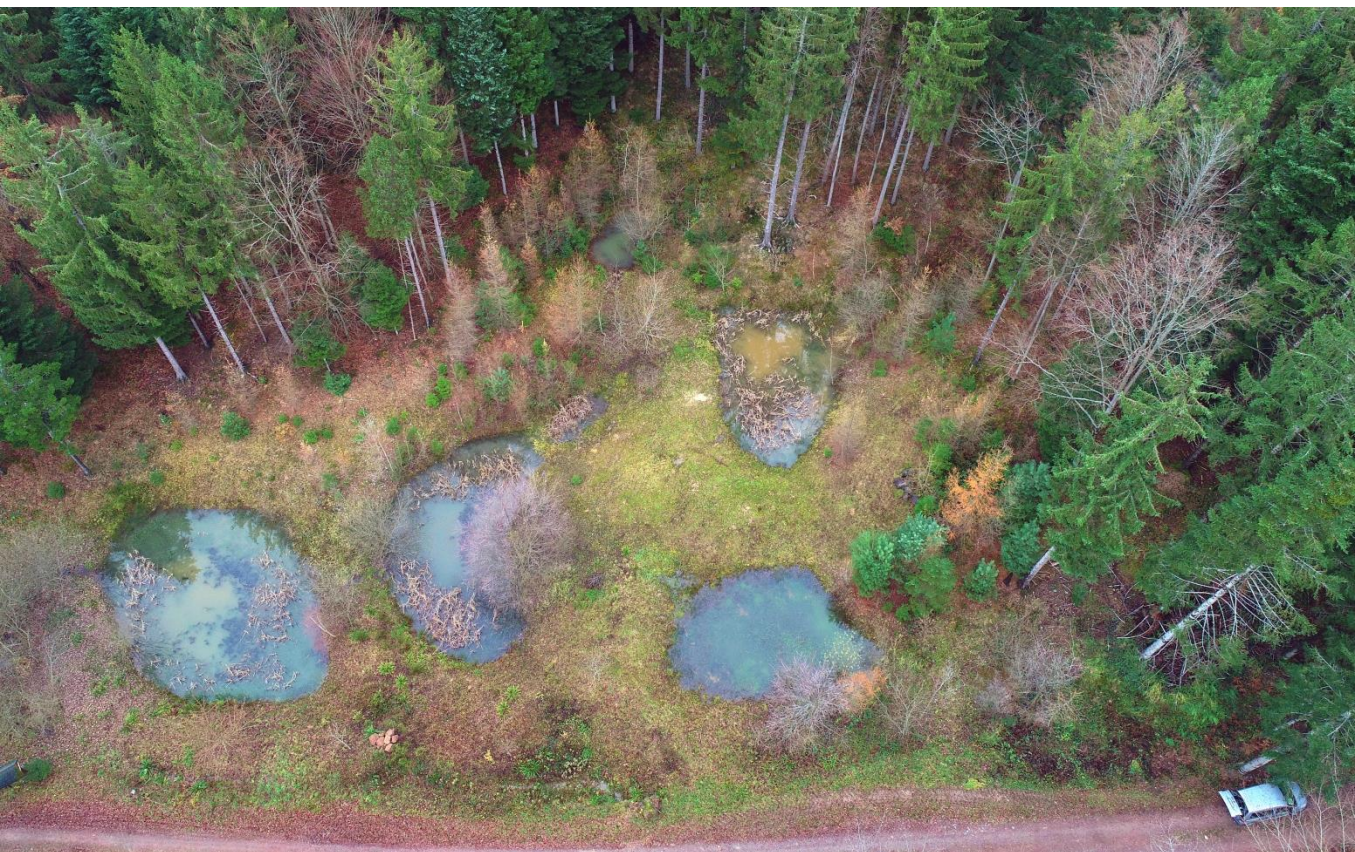
Abb. 32: Besonders wirksamer Wasserrückhalt durch Muldenkaskaden im Herbolzheimer Wald, Landkreis Emmendingen (Foto: J. Schmid).
